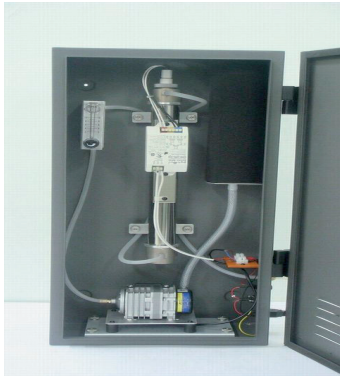
รูปที่ 3 เครื่องผลิตโอโซนโดยใช้รังสีอัลตราไวโอเลต (UV Ozone generator) ที่มา : www.silvermedicine.org สืบค้นใน www.google.com
