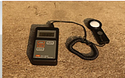
ภาพที่ 1 (ซ้าย) แสดงรูปแบบของหุ่นจำลอง (ขวา) แสดงเครื่องมือในการวัดแสง
