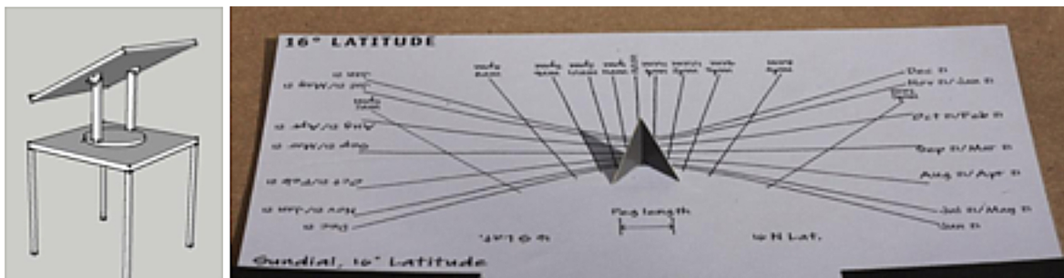
ภาพที่ 2 (ซ้าย) แสดงรูปแบบดวงอาทิตย์จำลอง (ขวา) แสดงการวัดแสงโดยใช้แผ่น Sundial Diagram และแท่งวัดแสง
