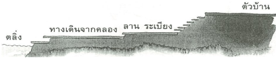
รูปที่ 9 แสดงภาพรวมของการปรับอากาศแบบทางอ้อมในบ้านทรงไทย
