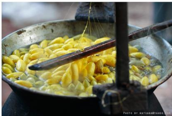
ภาพที่ 5-6: หม้อต้มรังไหม และวิธีการใช้ไม้สาวไหม (ภาพจาก: Watsana@yahoo.com)
