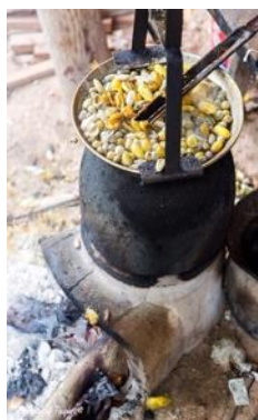
ภาพที่ 5-6: หม้อต้มรังไหม และวิธีการใช้ไม้สาวไหม (ภาพจาก: Watsana@yahoo.com)
