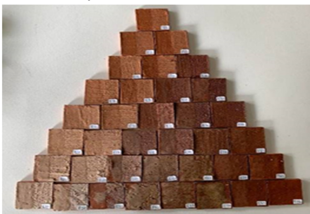
ภาพที่ 5 ผลการทดลองสีหลังเผาน้ำดินปากเกร็ด(เนื้อดินเอิร์ทเทนแวร์) จำนวน 36 จุด
