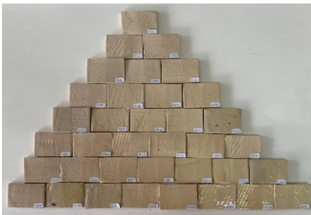
ภาพที่ 8 ผลการทดลองสีหลังเผา น้ำดินสโตนแวร์ จำนวน 36 จุด
