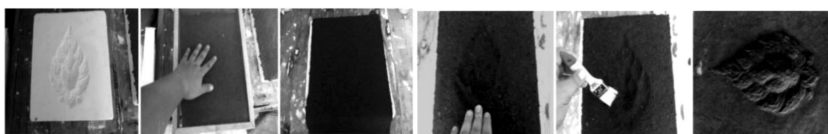
ภาพที่ 4 การทดลองขึ้นรูปผลิตภัณฑ์ด้วยการกดพิมพ์
