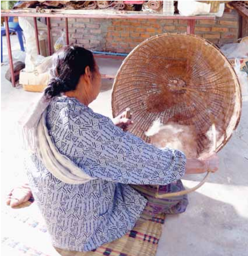
การตีฝ้าย คือการทำให้ฝ้ายละเอียดเป็นปุย Cotton flicking is to make cotton be cotton wool.
