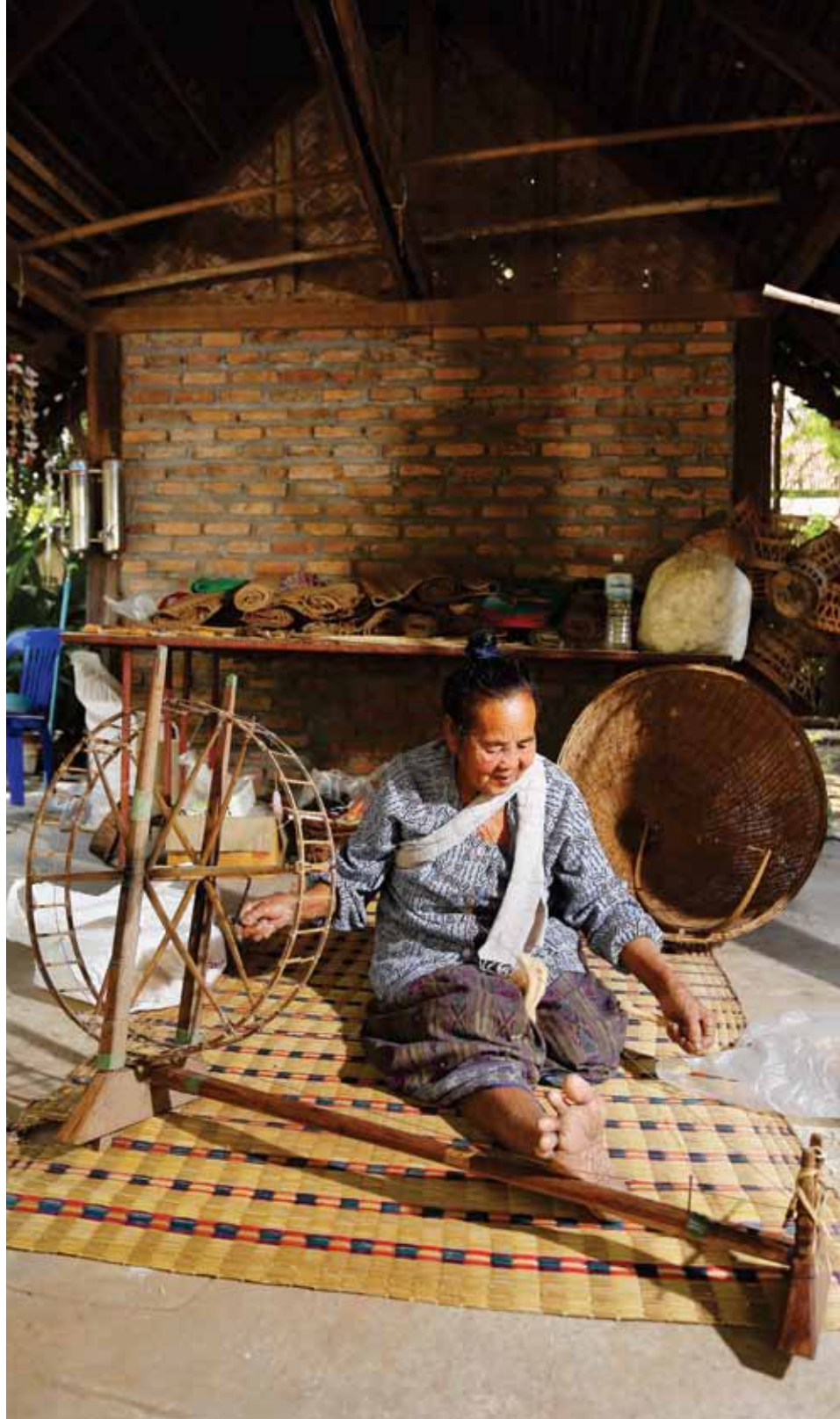
การปั่นฝ้าย คือ การทำปุยฝ้ายให้เป็นเส้นใยฝ้าย Ken-fai is to make the cotton fiber into cotton yarn.
