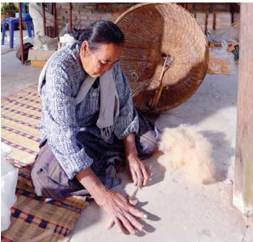
การตีฝ้าย คือการทำให้ฝ้ายละเอียดเป็นปุย Cotton flicking is to make cotton be cotton wool.
