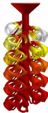
ภาพที่ 4 ภาพจำลองการไหลของโลหะลงในต้นขึ้นงาน
