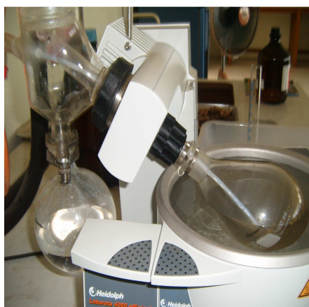
ภาพที่ 2 ซ้าย : การสกัดด้วยวิธีการแช่พืชในตัวทำละลาย ขวา : การระเหยตัวทำละลายด้วยเครื่องกลั่นระเหยแบบหมุน
