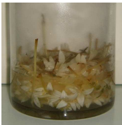
ภาพที่ 2 ซ้าย : การสกัดด้วยวิธีการแช่พืชในตัวทำละลาย ขวา : การระเหยตัวทำละลายด้วยเครื่องกลั่นระเหยแบบหมุน
