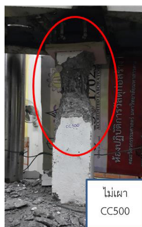
ภาพที่ 4 แสดงการวิบัติของเสาคอนกรีตเสริมเหล็กควบคุมก่อนการเผา
