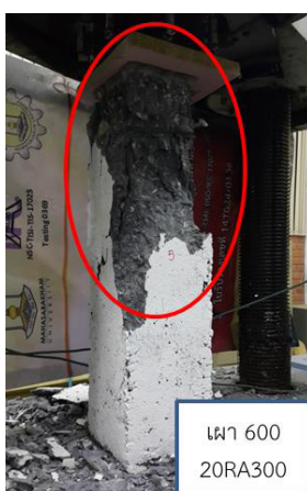
ภาพที่ 7 แสดงการวิบัติของเสาคอนกรีตเสริมเหล็กผสมเถ้าแกลบบดละเอียดร้อยละ 20 หลังการเผา
