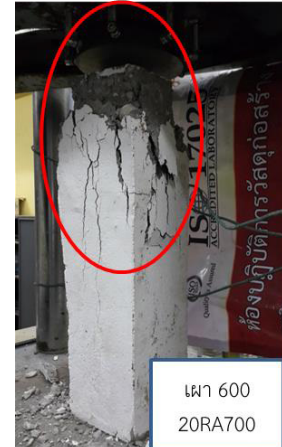
ภาพที่ 7 แสดงการวิบัติของเสาคอนกรีตเสริมเหล็กผสมเถ้าแกลบบดละเอียดร้อยละ 20 หลังการเผา
