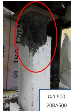
ภาพที่ 7 แสดงการวิบัติของเสาคอนกรีตเสริมเหล็กผสมเถ้าแกลบบดละเอียดร้อยละ 20 หลังการเผา
