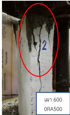
ภาพที่ 5 แสดงการวิบัติของเสาคอนกรีตเสริมเหล็กควบคุมหลังการเผา
