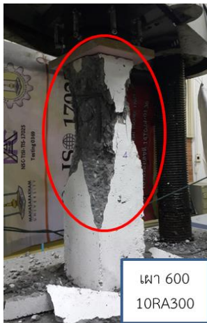
ภาพที่ 6 แสดงการวิบัติของเสาคอนกรีตเสริมเหล็กผสมเถ้าแกลบบดละเอียดร้อยละ 10 หลังการเผา
