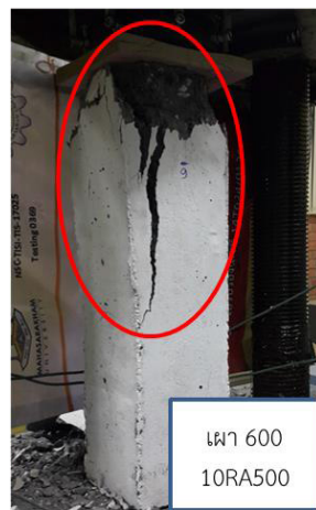
ภาพที่ 6 แสดงการวิบัติของเสาคอนกรีตเสริมเหล็กผสมเถ้าแกลบบดละเอียดร้อยละ 10 หลังการเผา
