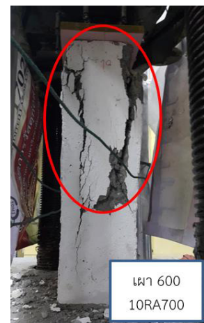
ภาพที่ 6 แสดงการวิบัติของเสาคอนกรีตเสริมเหล็กผสมเถ้าแกลบบดละเอียดร้อยละ 10 หลังการเผา
