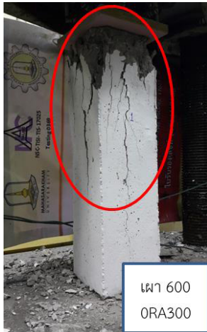
ภาพที่ 5 แสดงการวิบัติของเสาคอนกรีตเสริมเหล็กควบคุมหลังการเผา
