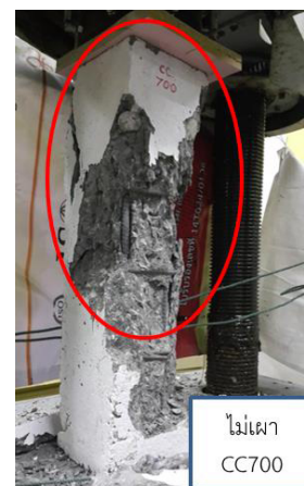
ภาพที่ 4 แสดงการวิบัติของเสาคอนกรีตเสริมเหล็กควบคุมก่อนการเผา
