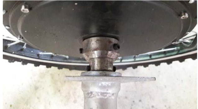
ภาพที่ 4 โครงสร้างจักรยานในส่วนจับยึดเฟลากลาง
