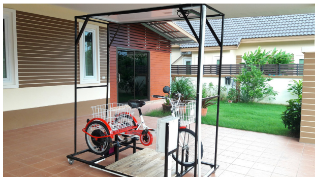
ภาพที่ 6 จักรยานปั่นร่วมกับพลังงานแสงอาทิตย์เพื่อผลิตกระแสไฟฟ้าสำหรับใช้ในครัวเรือน
