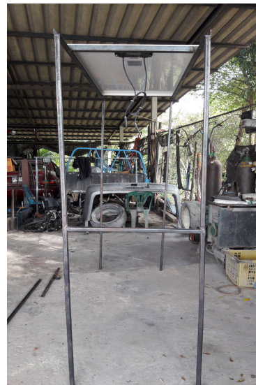
ภาพที่ 5 โครงสร้างแผงโซล่าเซลล์เพื่อรับพลังงานแสงอาทิตย์
