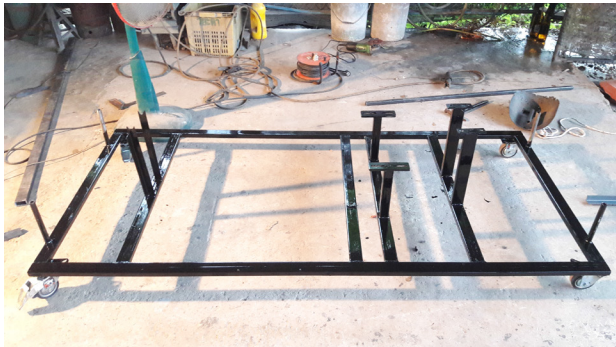
ภาพที่ 3 โครงสร้างจักรยานปั่นกระแสไฟฟ้าร่วมกับพลังงานแสงอาทิตย์
