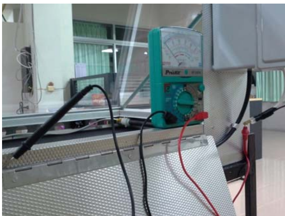
ภาพที่ 8 และ 9 การตรวจสอบการลงโครงในระบบไฟฟ้าและเตาอบพลังงานแสงอาทิตย์ระบบไฮบริดที่เสร็จสมบูรณ์
