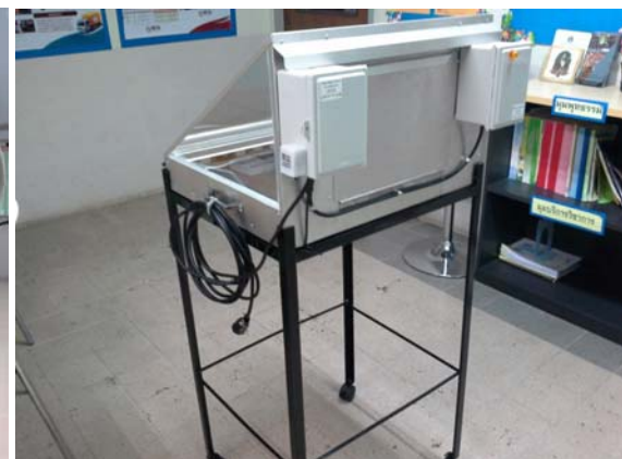
ภาพที่ 8 และ 9 การตรวจสอบการลงโครงในระบบไฟฟ้าและเตาอบพลังงานแสงอาทิตย์ระบบไฮบริดที่เสร็จสมบูรณ์
