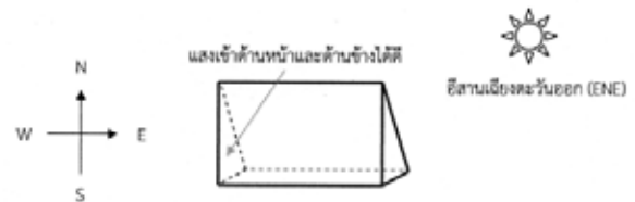
ภาพที่ 14 การจัดวางเตาอบพลังงานแสงอาทิตย์ทางทิศเหนือมีข้อดีคือจะทำให้รับแสงได้ตลอดทั้งวัน
