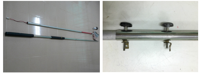
ภาพที่ 4 และ 5 แสดงลักษณะของด้ามไม้สอยที่ทำจากท่อสแตนเลสปลอดสนิมและลักษณะของประกับที่จัดสร้างขึ้น
