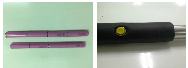
ภาพที่ 10 และ 11 แสดงลักษณะของแบตเตอรี่ชนิดลิเธียมไอออนและ Push Button Switch
