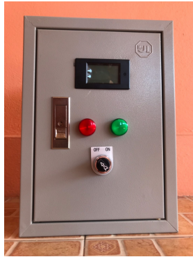
ภาพที่ 5 ตู้ควบคุมระบบปั๊มลมพลังงานแสงอาทิตย์ ภายใน และภายนอก
