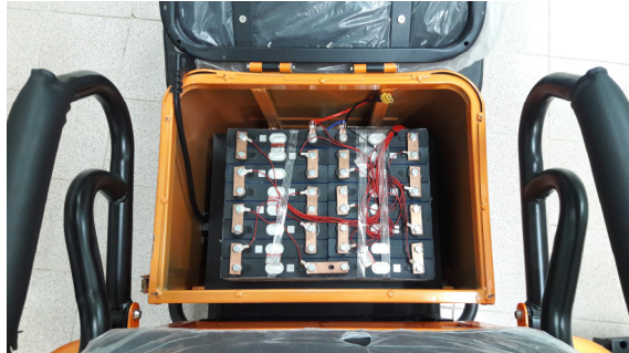
ภาพที่ 8 การติดตั้งแบตเตอรี่ลงในรถไฟฟ้า 3 ล้อขนาดเล็ก
