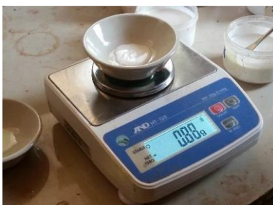
รูปที่ 6 ชั่งน้ำหนักน้ำยางสดก่อนนำอบ
