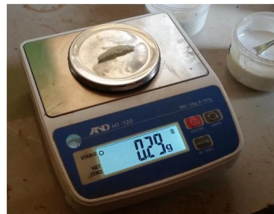
รูปที่ 7 ชั่งน้ำหนักยาง หลังจากนำอบเป็นเวลา 15 นาที
