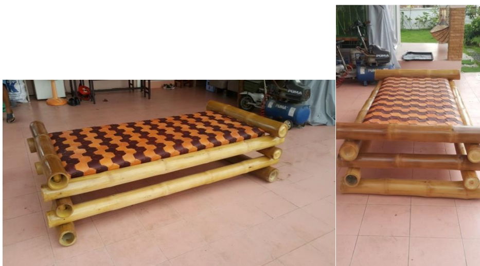
ภาพที่ 2 ต้นแบบเฟอร์นิเจอร์ประเภทลอยตัว เทคนิคการต่อหนังโครงสร้างจากไม้ไผ่
