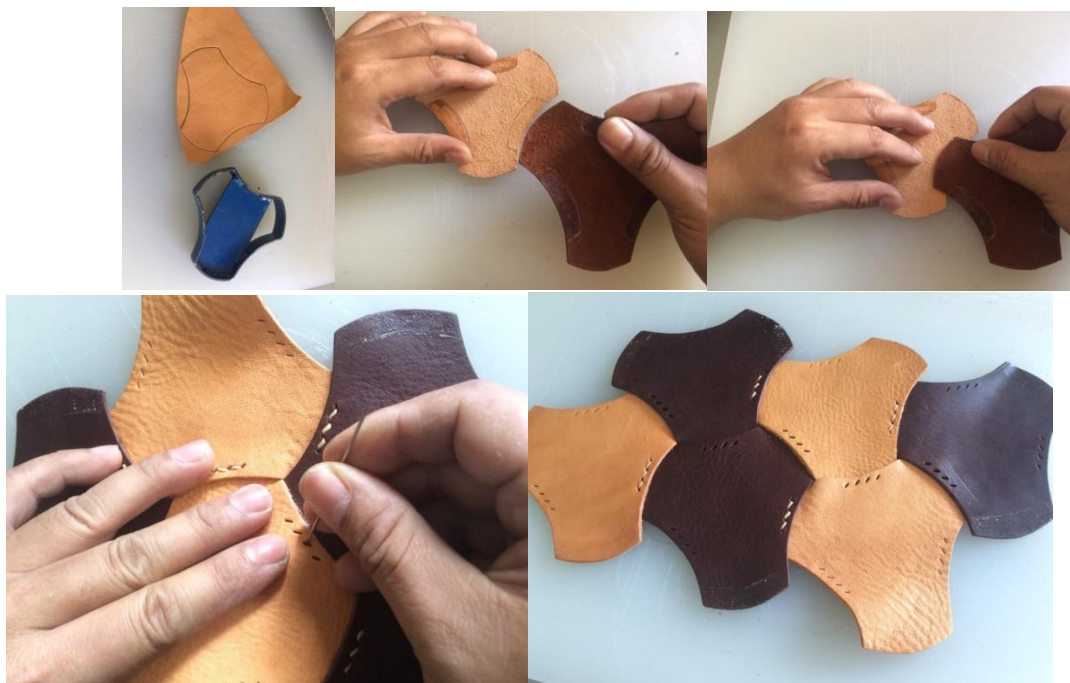
ภาพที่ 1 การต่อหนังแบบทับซ้อนโดยใช้บล็อกตัดก่อนนำไปเย็บต่อ
