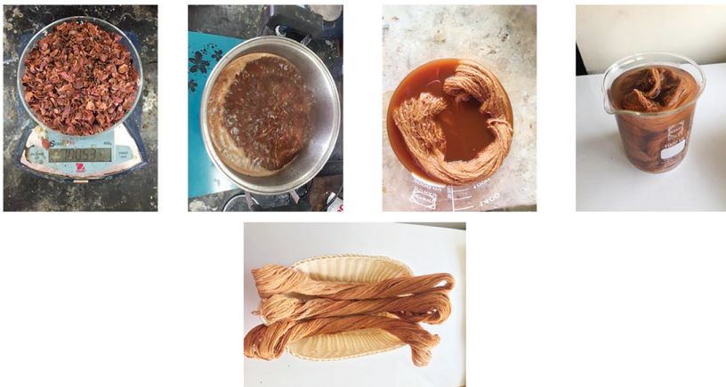
ภาพที่ 3 แสดงขั้นตอนกระบวนการย้อมสีจากกากเมล็ดโกโก้
