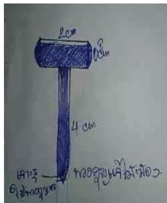
รูปที่ 3 ออกแบบด้วยการร่างภาพวาดเพื่อเป็นแบบในการกลึง ที่มา : ยิ่งศักดิ์ ชุ่มเย็น (2563)
