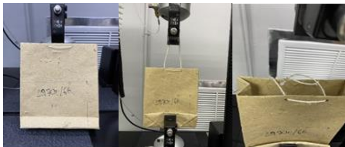
Figure 6 การทดสอบคุณสมบัติผลิตภัณฑ์จากกระดาษฟางข้าว รูปแบบที่ 1
