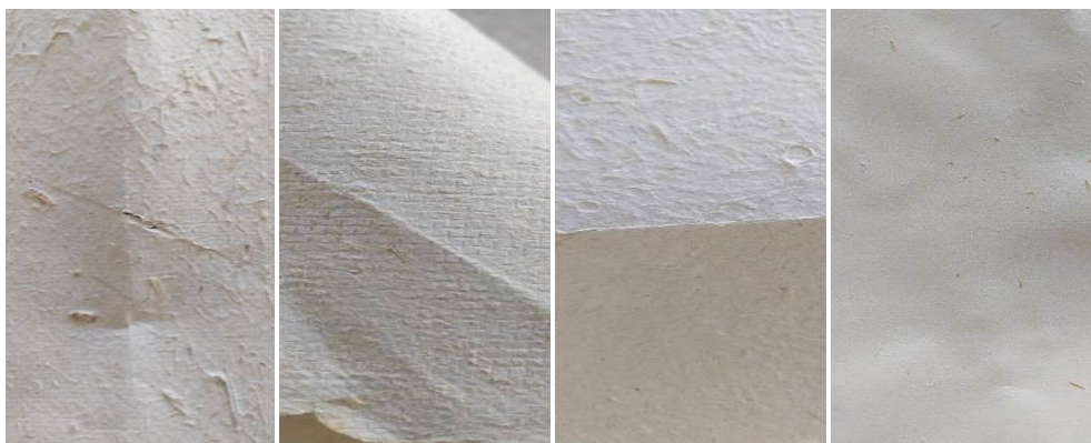
Figure 1 การเปรียบเทียบเนื้อกระดาษจากฟางข้าวที่ผ่านกระบวนการประสาน
