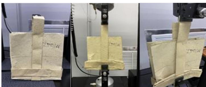
Figure 7 การทดสอบคุณสมบัติผลิตภัณฑ์จากกระดาษฟางข้าว รูปแบบที่ 2
