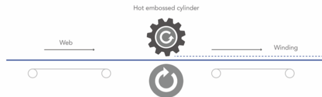
Figure 2 กระบวนการทำให้เส้นใยยึดเกาะด้วยการผ่านความร้อน (Thermal Bonding)
