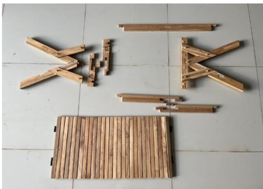
Figure 13 ต้นแบบชิ้นที่ 1 โต๊ะสนามจากเศษไม้สักเมื่อถอดแยกชิ้นส่วน Source : Suanchan (2025)
