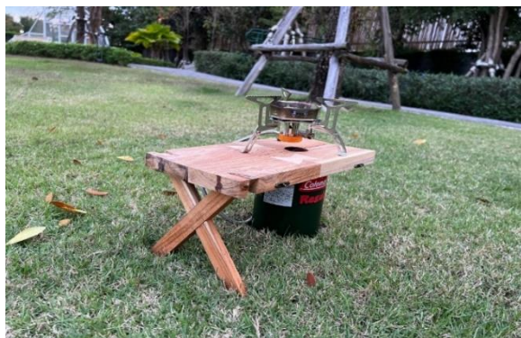
Figure 16 ต้นแบบชิ้นที่ 2 โต๊ะพับวางเตาแก๊สสนามเมื่อกางและประกอบพร้อมใช้งาน
