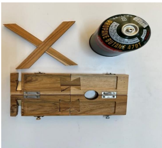
Figure 15 ต้นแบบชิ้นที่ 2 โต๊ะพับวางเตาแก๊สสนามเมื่อกางเปิดออกและเตรียมประกอบ Source : Suanchan (2025)
