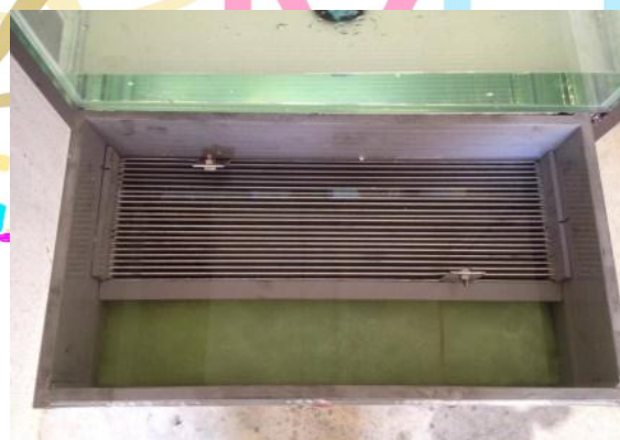
ภาพที่ 6 ลักษณะและการวางขั้วอิเล็กโทรด
