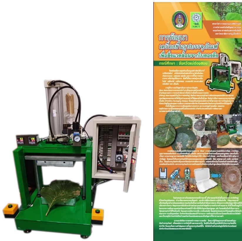
ภาพต้นแบบเครื่องขึ้นรูปบรรจุภัณฑ์เพื่อสิ่งแวดล้อม จากใบตองตึง
