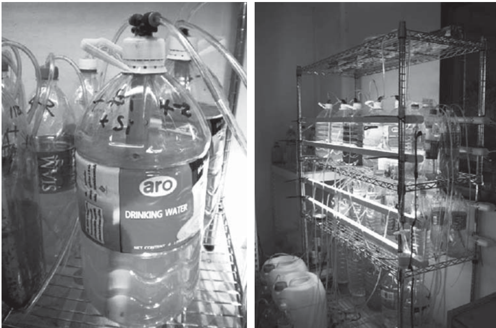
ภาพที่ 1 แสดงระบบไบโอรีแอคเตอร์ที่ผลิตจากขวดพลาสติก
