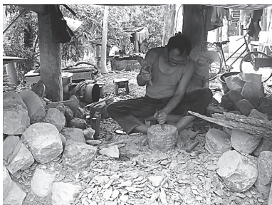
ภาพที่ 6 ลักษณะวิธีการเจาะครกหินด้วยมือ
