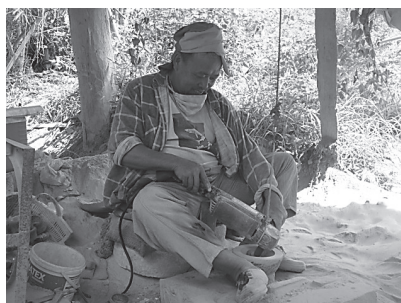
ภาพที่ 11 ลักษณะในการเจียรภายในของครกหินเพื่อให้มีความเรียบก่อนนำไปใช้งาน
