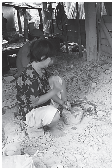
ภาพที่ 16 เศษวัสดุที่ได้จากการกะเทาะให้เป็นรูปทรงครกหิน จะกลายเป็นเศษวัสดุที่มีขนาดเล็กและมีความบางมาก
