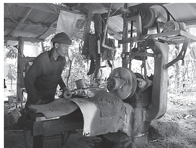
ภาพที่ 8 ลักษณะของเครื่องกลึงครกและลักษณะการใช้งานของเครื่อง
