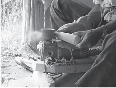
ภาพที่ 12 ลักษณะในการเจียรสากเพื่อให้มีความเรียบก่อนนำไปใช้งาน
