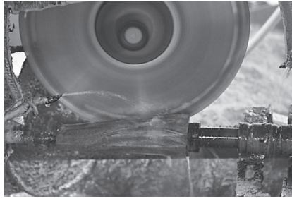
ภาพที่ 18 ลักษณะในกรรมวิธีผลิตสากโดยใช้การตัดขอบสากโดยใช้เครื่องจักรและน้ำเป็นตัวหล่อลื่น
