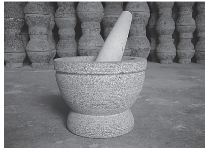
ภาพที่ 13 ชิ้นงานครกหินที่ได้ ทำการขัดตกแต่งเป็นที่เรียบร้อยแล้ว
