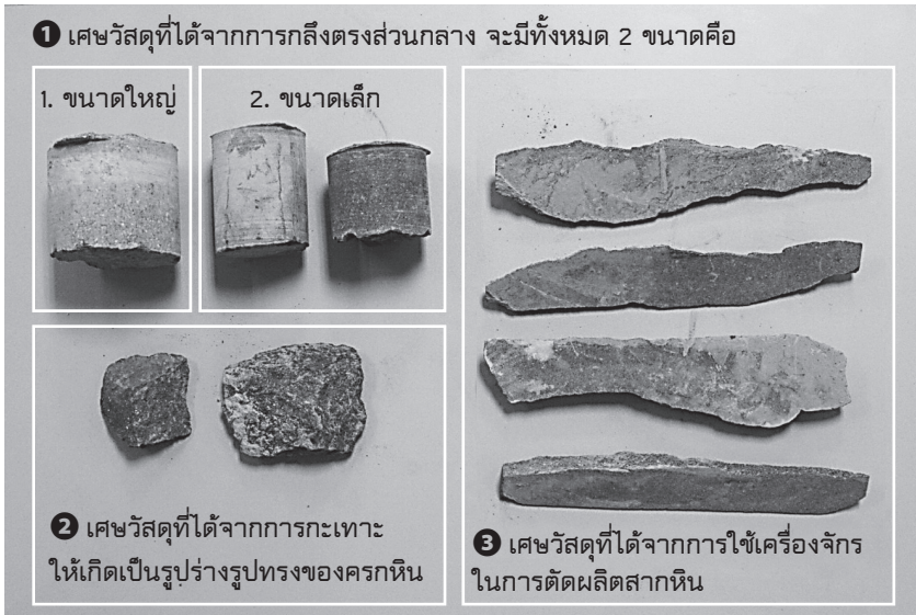
ภาพที่ 20 ลักษณะของเศษวัสดุที่ได้จากการผลิตครกหินที่จะนำมาใช้เข้าสู่กระบวนการออกแบบและพัฒนาผลิตภัณฑ์
