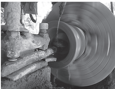
ภาพที่ 8 ลักษณะของเครื่องกลึงครกและลักษณะการใช้งานของเครื่อง
