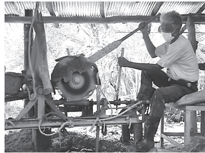
ภาพที่ 9 ลักษณะของเครื่องปาดสากและลักษณะการใช้งานของเครื่องปาดสาก
