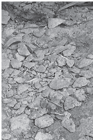
ภาพที่ 16 เศษวัสดุที่ได้จากการกะเทาะให้เป็นรูปทรงครกหิน จะกลายเป็นเศษวัสดุที่มีขนาดเล็กและมีความบางมาก
