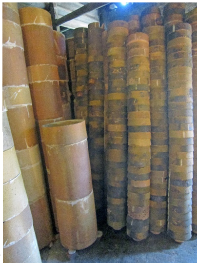
ภาพที่ 7 : จีหรือหีบหนไฟ (sagger) สำหรับบรรจุชิ้นงานพวกแจกัน ขามหรือจานระดับเนื้อเครื่องกระเบื้องประณีต เพื่อนำไปเข้าเตาเผาโดยนำมาวางเรียงซ้อนกัน แต่แถวของหีบหนไฟที่ซ้อนนี้จะวางห่างกันราว 2-3 นิ้ว โดยมีตัวเสริมวางชั้นระหว่างแถวของหีบหนไฟ (ที่มา : 26 ก.ค. 2555)
