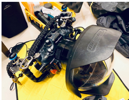
ภาพที่ 6 กล้องถ่ายภาพที่ใช้ในการบันทึกภาพใต้น้ำ(ซ้าย) / กรอบกันน้ำของกล้องถ่ายภาพใต้น้ำ(ขวา). ที่มา กิตติรัช ศรีฟ้า
