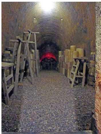
ภาพที่ 6 : ภายในบริเวณห้องเผาของเตา มีการวางเรียงภาชนะที่บรรจุอยู่ ภายในหีบหนไฟเพื่อเตรียมเผา จะสังเกตเห็นพื้นเตาที่มีความลาดเอียงสูงขึ้นไป ด้านท้ายเตา สูงกว่าระดับบริเวณ พื้นด้านหน้าเตา (ที่มา : 26 ก.ค. 2555)
