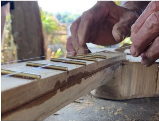
ภาพที่ 8 การติดลูกซึง (ที่มา : ภาพถ่ายโดยผู้เขียน)
