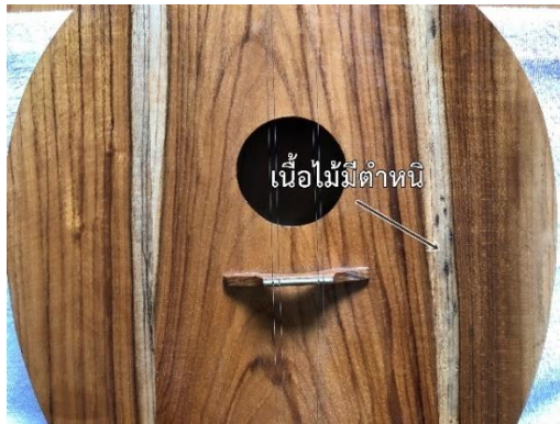
ภาพที่ 12 รอยตำหนิบนเนื้อไม้ (ที่มา : ภาพถ่ายโดยผู้เขียน)
