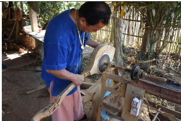
ภาพที่ 7 การขัดตัวซิงให้เรียบเนียน (ที่มา : ภาพถ่ายโดยผู้เขียน)
