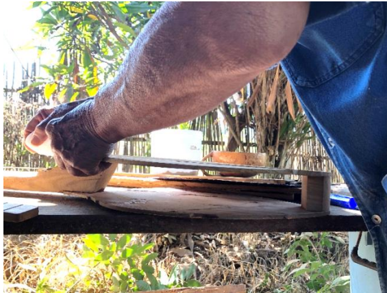
ภาพที่ 5 การประกอบกล่องเสียงซิ่ง (ที่มา : ภาพถ่ายโดยผู้เขียน)
