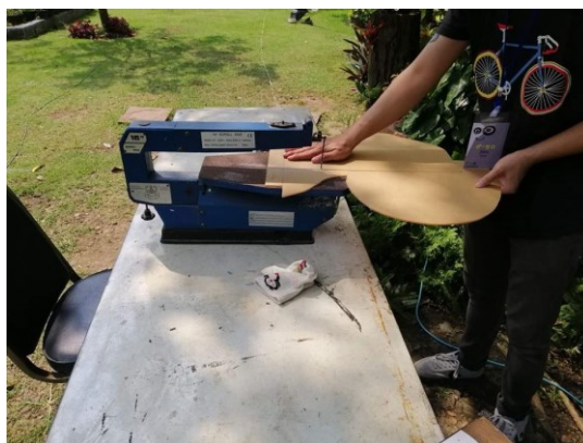
ภาพที่ 4 การตัดแผ่นอะคริลิกชนิดใสด้วยแท่นเลื่อยฉลุไฟฟ้า
