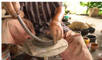
ภาพที่ 8 ขึ้นรูปด้วยมือแบบมอญ/ขึ้นรูปบนแป้นหมุน
