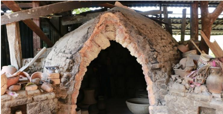
ภาพที่ 10 การเผาและเข้าเตาอุโมงค์เครื่องปั้นดินเผาบ้านมอญ
