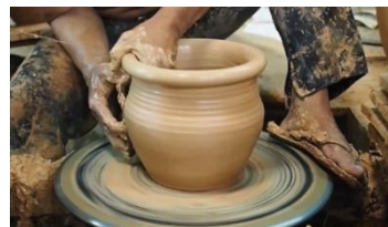
ภาพที่ 8 ขึ้นรูปด้วยมือแบบมอญ/ขึ้นรูปบนแป้นหมุน
