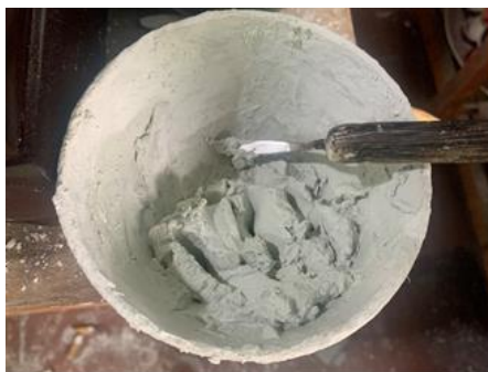
ภาพที่ 1 ปูนที่นวดเสร็จเรียบร้อยแล้วเตรียมใช้ ที่มา: Liu Jian (2566)
