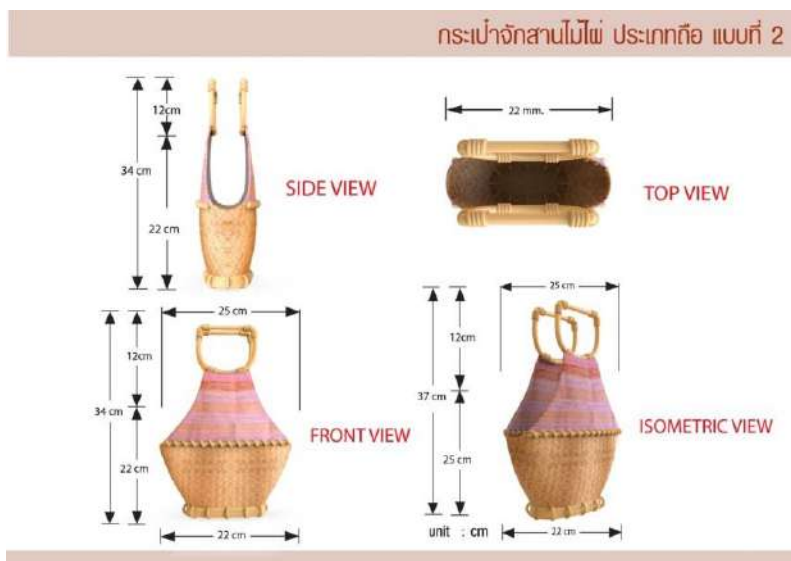
ภาพที่ 11 ผลงานออกแบบกระเป๋าจักสานไม้ไผ่และงานทอ ประเภทกระเป๋าทือ แบบที่ 2 ที่มา : ผู้วิจัย (2563)
