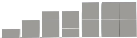
ภาพที่ 10 ภาพแสดงขนาดสัดส่วนของเครื่องเรือนแบบอเนกประสงค์ของยูนิตย่อยที่เหมาะสมในการต่อขยายสำหรับการใช้งาน มีขนาดความสูง 2 ขนาด คือ 15 และ 30 เซนติเมตร
