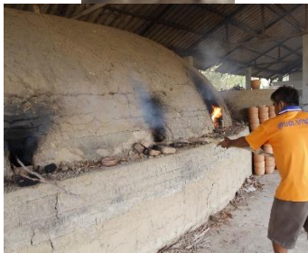
ภาพที่ 13 ภาพช่องใส่เชื้อเพลิงด้านข้างเตาและการเผา ที่มา : ภาณุ พัฒนปณิธิพงศ์. (2558). ถ่ายภาพ
