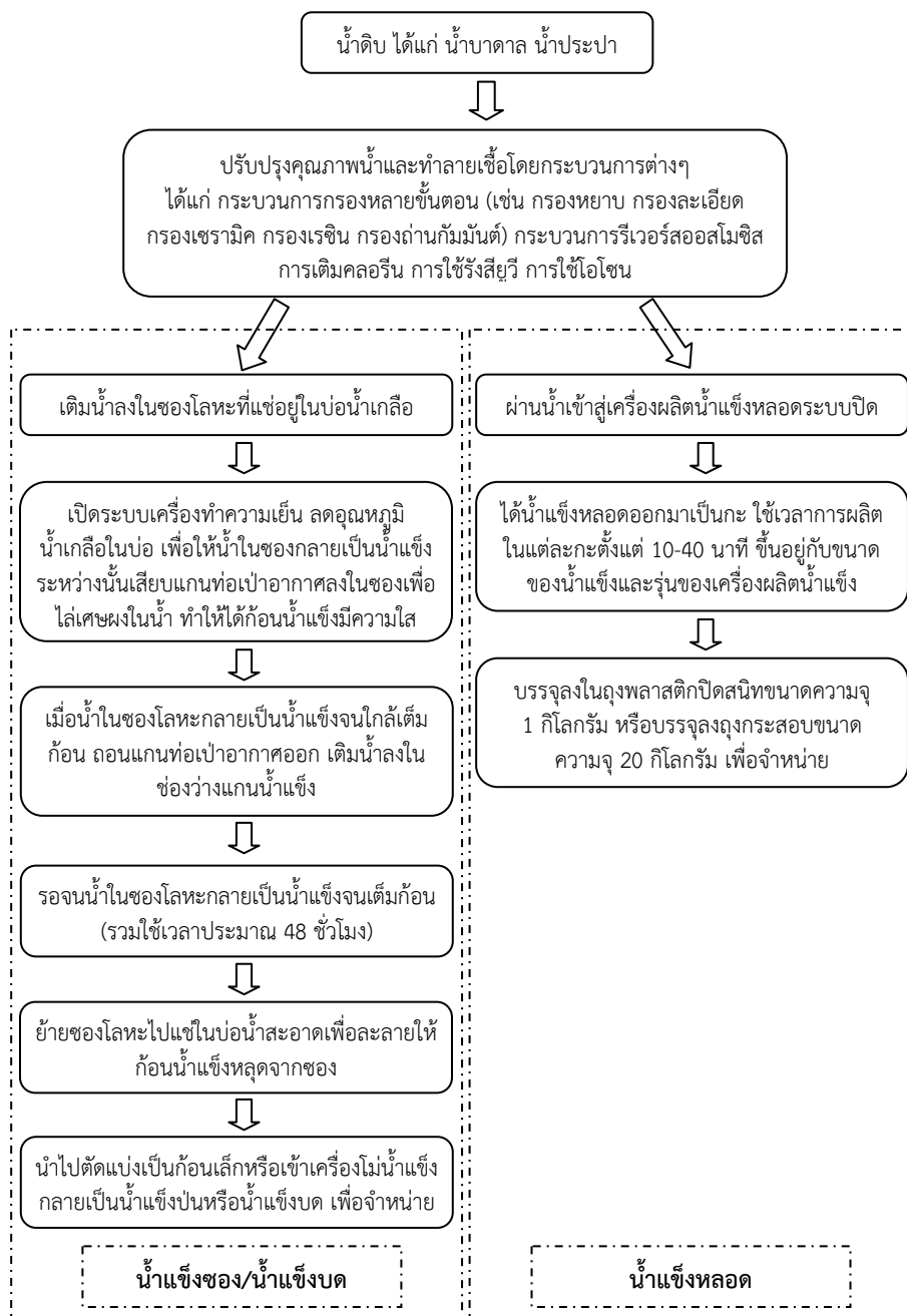
แผนภาพที่ 1 แผนผังกระบวนการผลิตน้ำแข็งซองและน้ำแข็งหลอด (ปรเมษฐ์ มังกรพานิชย์, 2549; Tvburabha Official, 2015)
