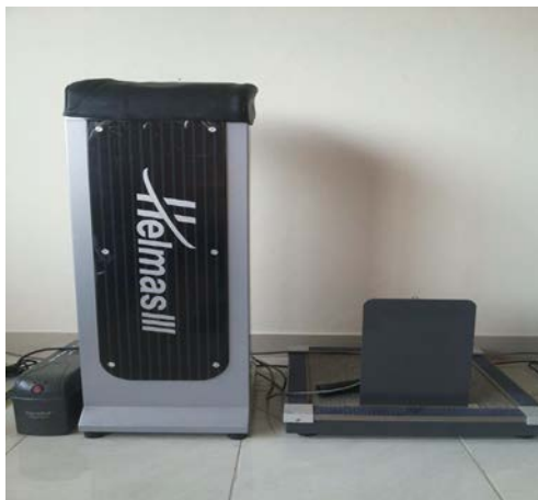
ภาพที่ 2 เครื่องวัดความแข็งแรงของกล้ามเนื้อขา ด้วยเครื่อง Helmas Back and leg strength
