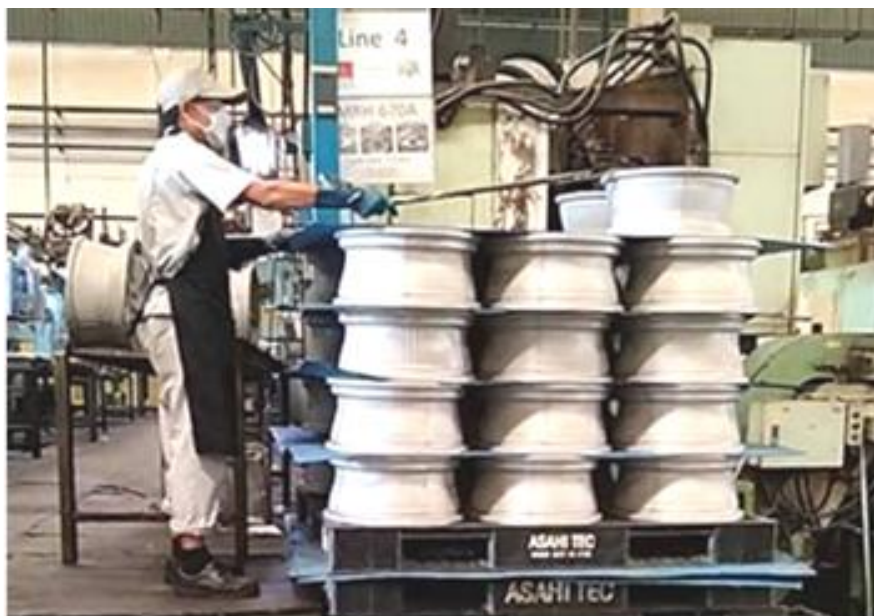
ภาพที่ 4 ปรับปรุงสภาพการทำงานให้พนักงานใช้เหล็กด้ามยาวส่วนปลายมีขอสำหรับเกี่ยววงล้อ ที่มา : บันทึกภาพโดย เคียวสุเกะ (วรุฒิ) พุกม่า
