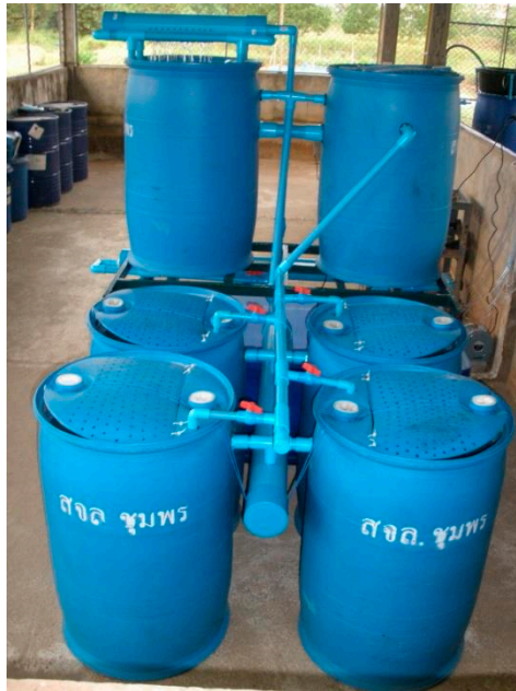
ภาพที่ 6 ผลงานสร้างสรรค์ชุดถังเลี้ยงปลาในระบบน้ำหมุนเวียน
