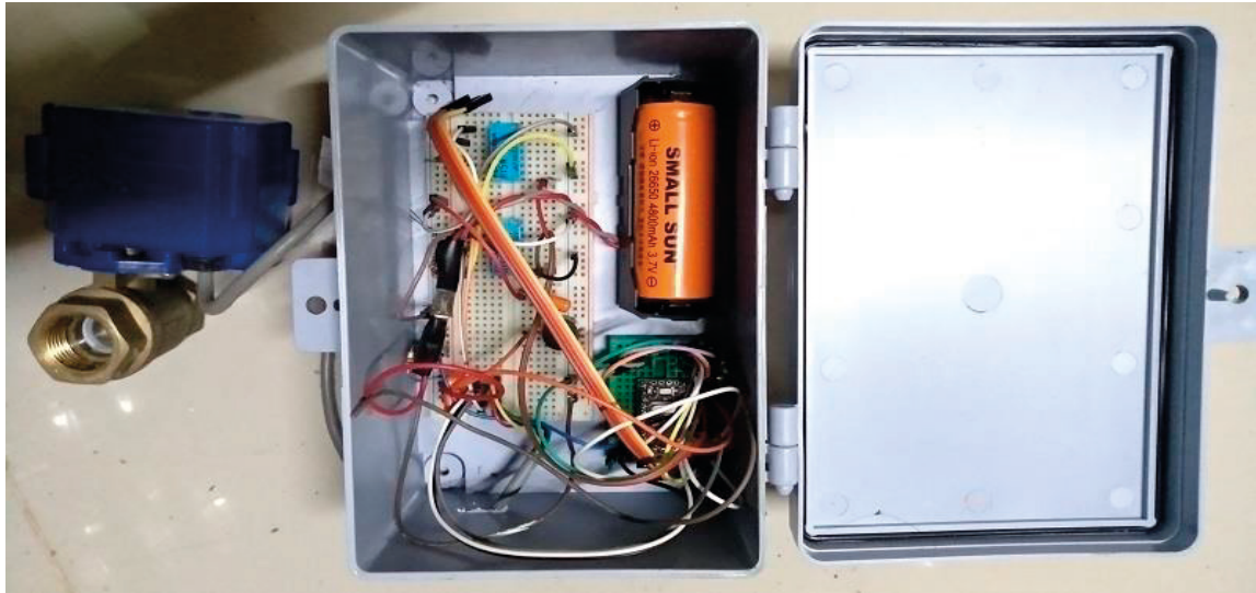
ภาพที่ 5 เครื่องต้นแบบระบบวาล์วน้ำแบบไร้สายพลังงานต่ำผ่านอินเทอร์เน็ตของระบบสมาร์ทโฮม
