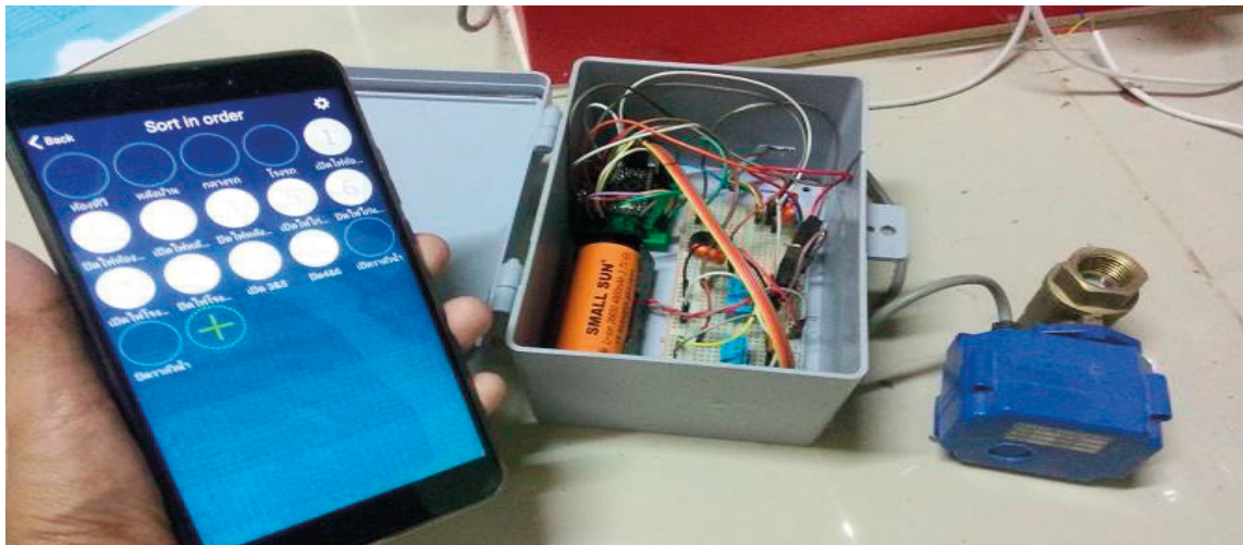
ภาพที่ 6 แอปพลิเคชันที่ใช้กับระบบสมาร์ทโฮมสำหรับควบคุมเครื่องต้นแบบระบบการเปิด-ปิดวาล์วน้ำ
