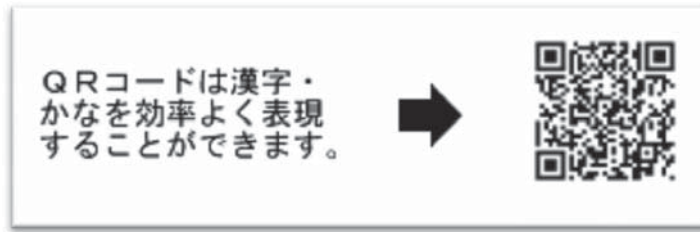
รูปที่ 3 การ encode ตัวอักษรภาษาญี่ปุ่นให้อยู่ในรูปแบบ QR Code
