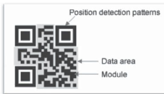
รูปที่ 5 แสดงโครงสร้างของ QR Code
