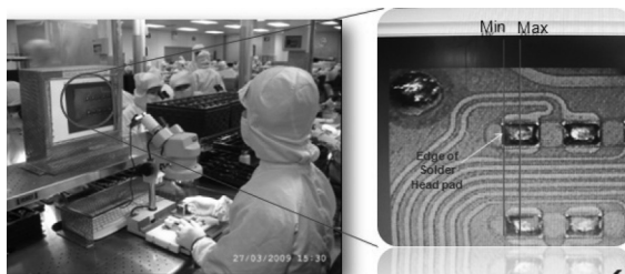
รูปที่ 3: ระบบการตรวจเช็คตำแหน่ง Solder head pad แบบเดิม
