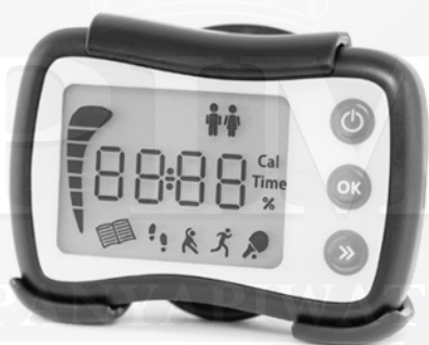
ภาพที่ 1 แสดงอุปกรณ์ตรวจวัดระดับกิจกรรมทางกายฟีลฟิต (FeelFit®)
