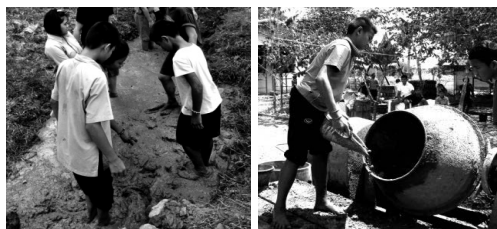
ภาพที่ 6 (ซ้าย) การย่ำดินด้วยเท้าเป็นวิธีการผลิตอิฐดินแบบดั้งเดิม และ ภาพที่ 7 (ขวา) การใช้ไม้ผสมปูนเพื่อทุ่นแรงแทนการย่ำดินแบบดั้งเดิม
