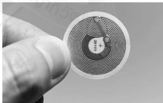
ภาพที่ 4 NFC Tag ในรูปแบบของสติ๊กเกอร์ (Triggs, 2016)
