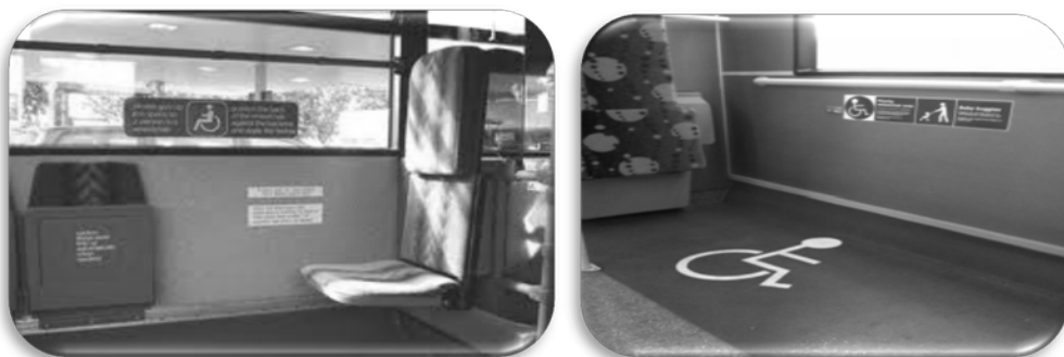
รูปภาพ 3 ประเทศอังกฤษ – รถโดยสารประจำทางสำหรับคนพิการที่ใช้รถเข็นทางลาดติดกับตัวรถมีป้ายรถประจำทางที่แสดงให้รู้ว่าคนพิการที่ใช้รถเข็นสามารถขึ้นรถประจำทางได้เอง ภายในรถประจำทางมีพื้นที่ว่างสำหรับจอดรถเข็นและเก้าอี้สำหรับคนพิการ
