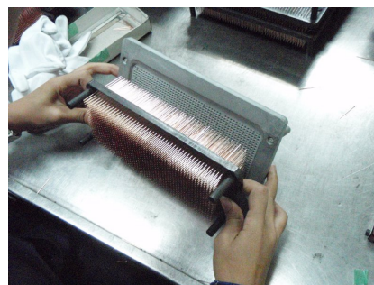
รูปที่ 14 ตรวจสอบชิ้นงานในโบทที่ออกจากเตาบัดกรี
