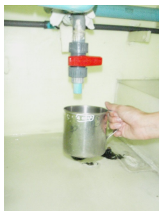
รูปที่ 5 ล้างได้ด้วยน้ำร้อนที่ปราศจากไอออน
