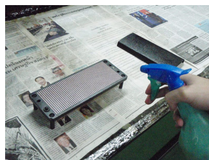
รูปที่ 10 วิธีการฉีดฟลักเข้าสู่แผ่นตะกั่วและขาทองแดง
