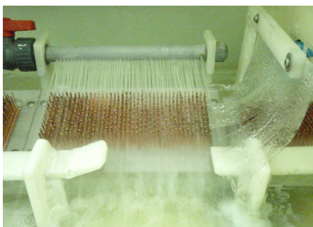
รูปที่ 18 ชิ้นงานผ่านกระบวนการล้างด้วยน้ำ DI
