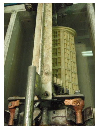
รูปที่ 23 บ่อที่ 17 ล้างด้วยน้ำ DI (อุณหภูมิปกติ)
