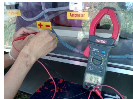
รูปที่ 5 วัดแรงดันที่ผลิตได้เมื่อความเร็วลมเปลี่ยนแปลง
