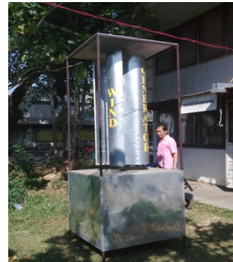
รูปที่ 4 กังหันลมทรงกระบอกเมื่อประกอบแล้วเสร็จ
