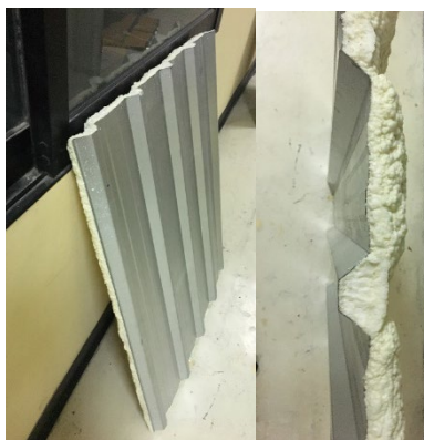
ภาพ 4 แผ่นเหล็กมุงหลังคาสำเร็จรูปฉีดยาฉนวนโฟม PU หนา 25 มิลลิเมตร
