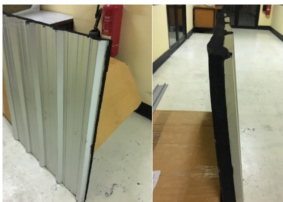
ภาพ 5 แผ่นเหล็กมุงหลังคาสำเร็จรูปรีดด้วยฉนวนยางดำหนา 25 มิลลิเมตร
