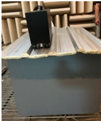
ภาพ 7 แสดงการทดสอบคุณสมบัติทางเสียงของแผ่นเหล็กมุงหลังคาสำเร็จรูปโดยฉนวนโฟม PU
