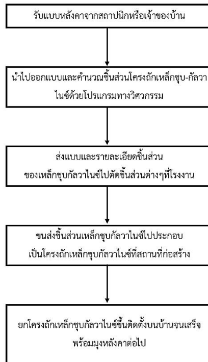
แผนภูมิ 1 ขั้นตอนการดำเนินงานผลิตชิ้นส่วนเหล็กชุบกัลวาไนซ์ บริษัท ปูนซิเมนต์ไทย จำกัด (มหาชน)
